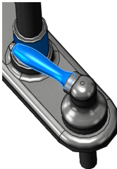
Baugruppe Wasserhahn mit aktivierter Kollisionsprüfung , Stopp bei Kollision
