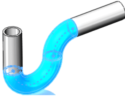
Fonctions basées sur des esquisses : balayage de base pour le tuyau d'évacuation
