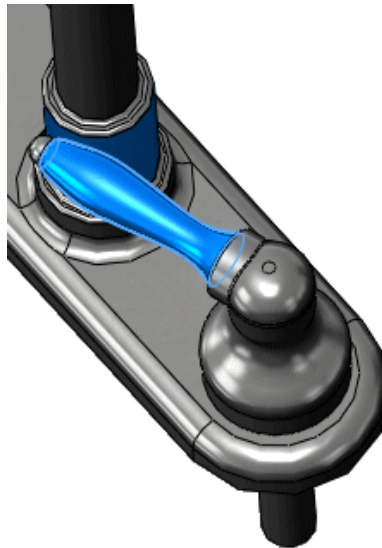
Assemblage de robinetterie avec Détection de collision , option Arrêter à la collision activée
